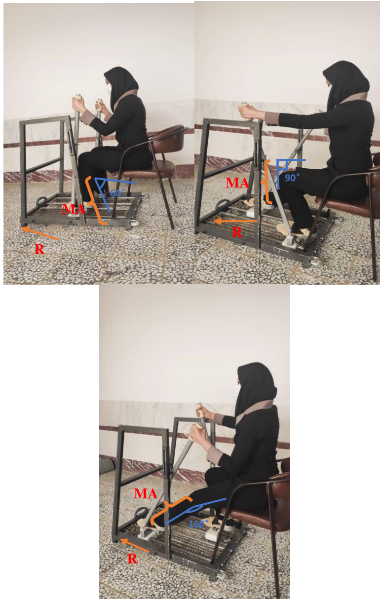
شکل ۱۱- ثابت بودن بازوی گشتاوری در زوایای مختلف زانو در تمرین با دستگاه M K-H SD؛ زاویه ۶۰ درجه زانو برابر با ۱۲۰ درجه فلکسیون و زاویه ۱۶۰ درجه زانو برابر با ۲۰ درجه اکستنسیون
