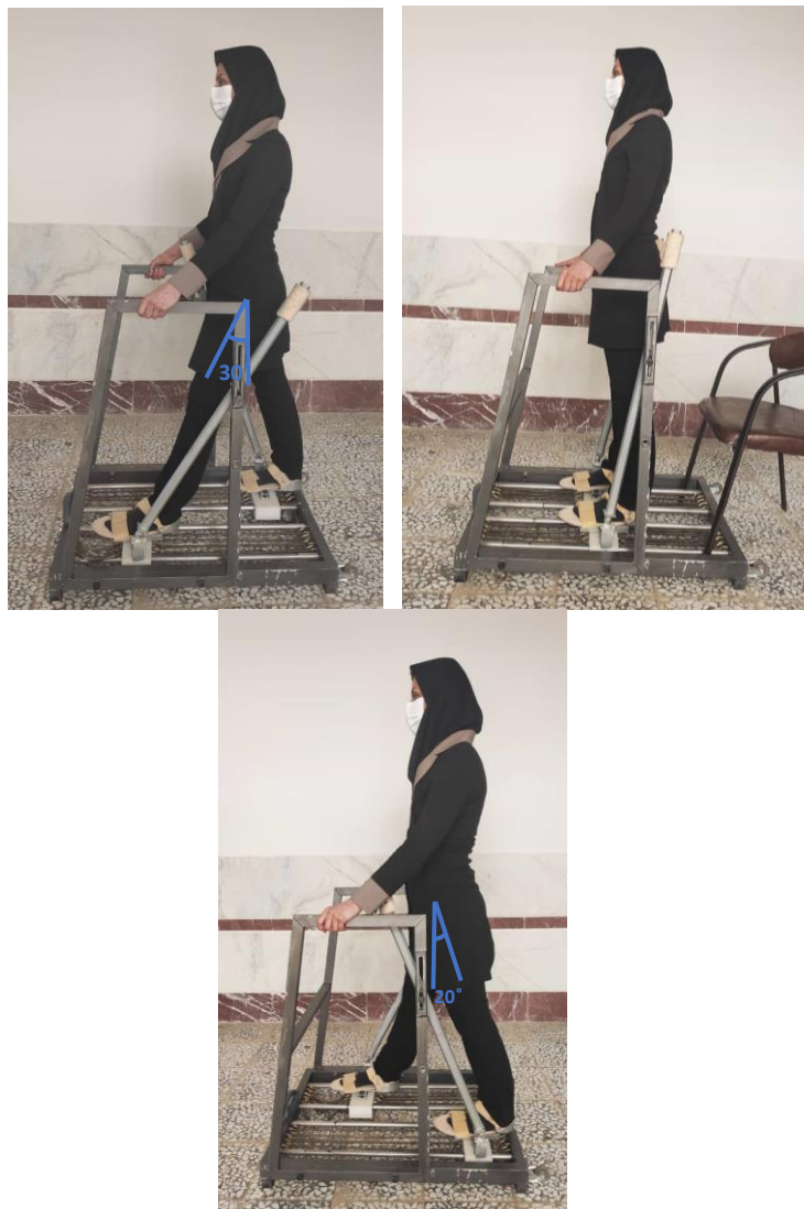
شکل ۱۲- زوایای مفصل ران؛ در یک سیکل راه رفتن نرمال زاویه مفصل ران در حرکت فلکسیون حدود ۳۰ درجه و در حرکت اکستنسینون حدود ۲۰ درجه است.
