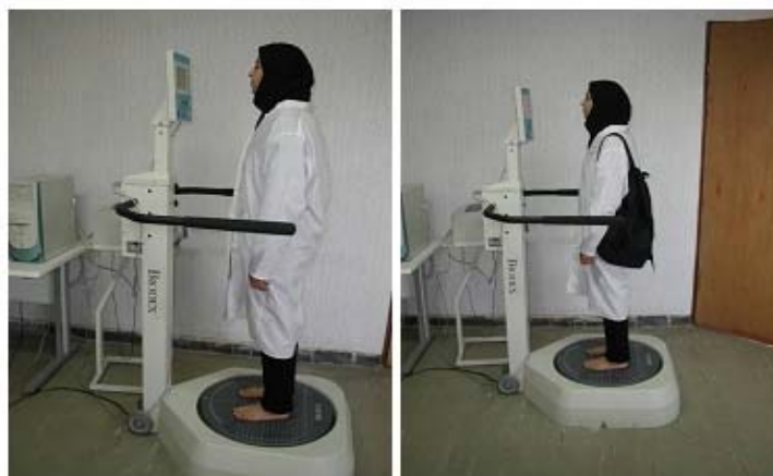
تصویر ۱. نحوه قرارگیری آزمودنی روی صفحه تعادل سنج
