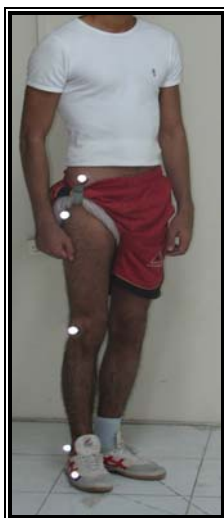
تصویر ۱. نحوه نصب نشانگرها
